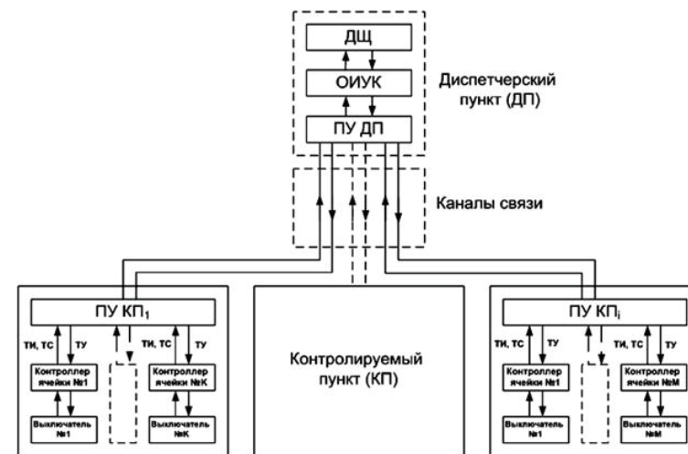
Рис. 1. Схема работы технических средств в автоматизированной системе диспетчерского управления электроснабжением. ДЩ – диспетчерский щит, ОИУК – оперативно-информационный управляющий комплекс, ПУ – приемное устройство. Сигналы: ТИ – телеизмерения, ТС – телесигнализации, ТУ – телеуправления.
